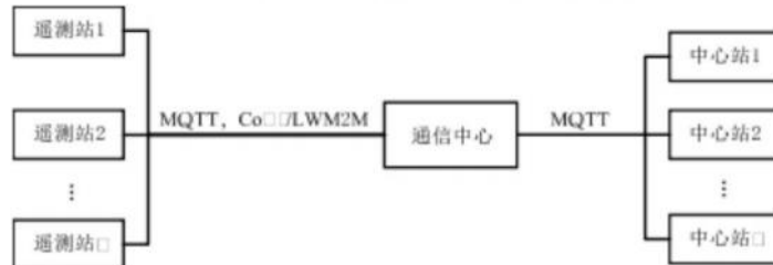
图 7 通信中心工作模式逻辑结构图
